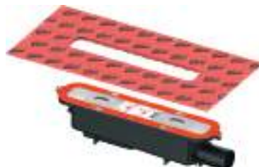
TECEdrainprofile 673002 Sifón s bočným odpadom DN50, minimálna montážna výška 95 mm, prietok odpadovej vody max. 0,8 l/s
