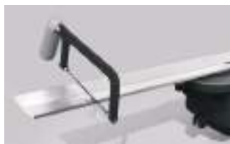
Nerezový profil môže byť skrátенý po oboch stranách, aby sa presne prispôbil rozmerom sprchy
