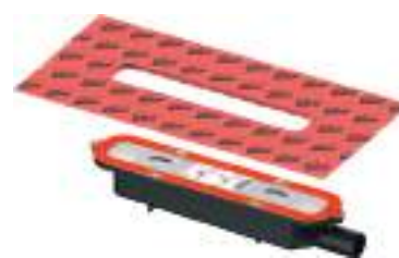
TECEdrainprofile 673001 Sifón s bočným odpadom DN40, minimálna montážna výška 65 mm, prietok odpadovej vody max. 0,53 l/s
