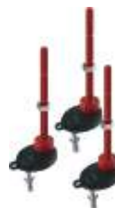
TECEdrainprofile 673001 Sifón s bočným odpadom DN40, minimálna montážna výška 65 mm, prietok odpadovej vody max. 0,53 l/s
